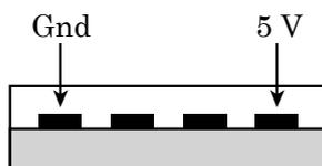
図 17 USB 端子を正面から見たときの電極配置
