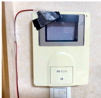
(a) インターホンの親機に取り付けた光センサ
