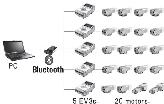
図7 出力機構制御システムの概要図
