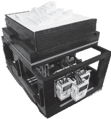
図10 地形再現ロボットシステム
